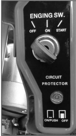
Рис.7 Замок зажигания и предохранитель
