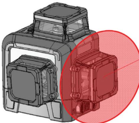
Следующее (шестое) нажатие на кнопку включения включает все линии - обе вертикальных и горизонтальную, то есть повторяет стартовое положение прибора. Дальнейшие нажатия кнопки позволяют перебирать уже показанные режимы работы (сочетания вертикальных и горизонтальной линий) в указанном порядке.
