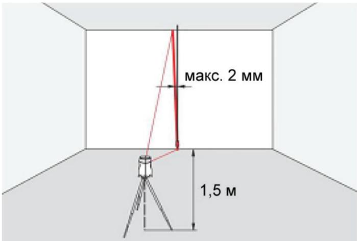
Установите прибор на расстоянии приблизительно 1,5 м от стены :
