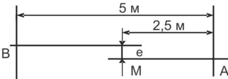
Отмерьте по горизонтальной линии примерно 2,5 м влево и поставьте точку «М».
