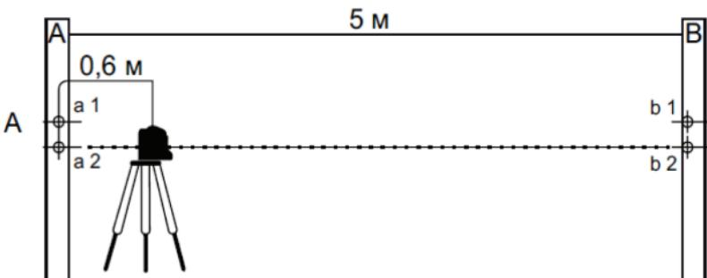
Если расстояния  $\{a_1-a_2\}$  и  $\{b_1-b_2\}$  отличаются друг от друга меньше, чем на 1,2 мм, то точность Вашего прибора в допустимых пределах. Если точность прибора не соответствует заявленной, необходимо обратиться в авторизованный сервисный центр.
