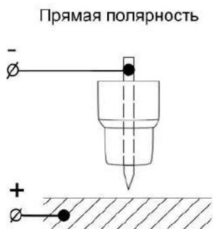
Рис. 9.2.1. Полярность при TIG сварке.
